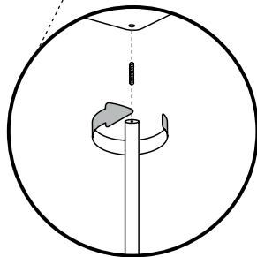
Вкрутите резьбовые шпильки в ножки
