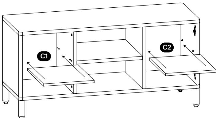
Установите дверки с установленными петлями на ответные
