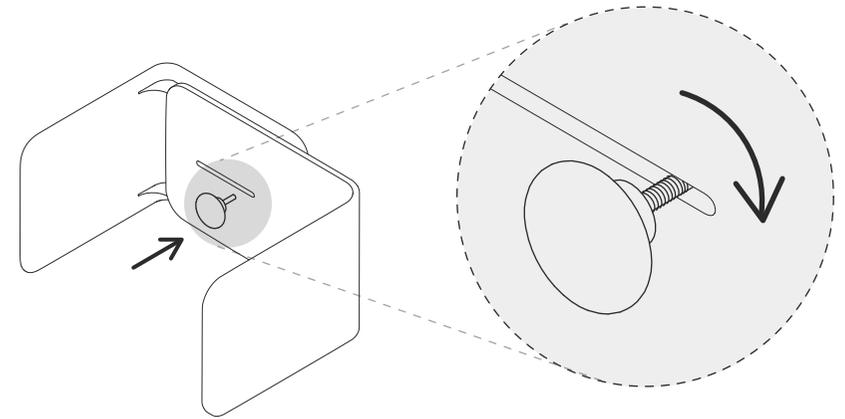
**3** Закрепите столешницу с помощью барашка. Закручивайте по часовой.
