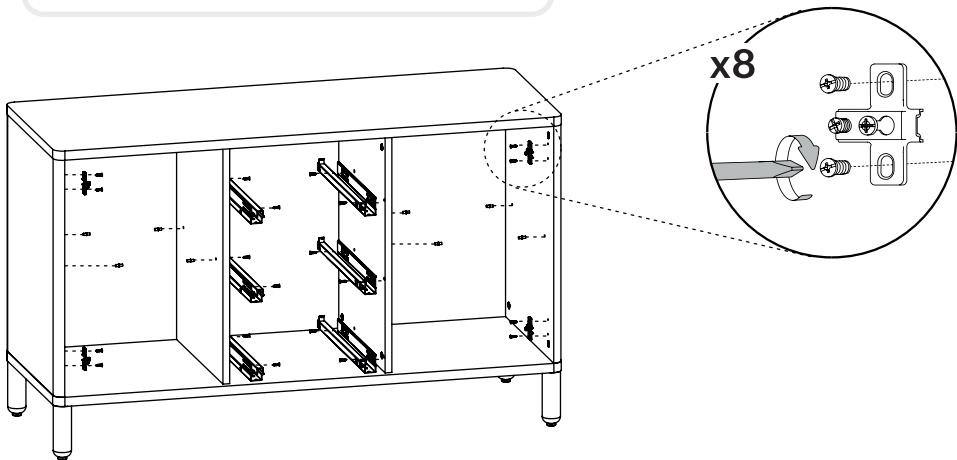
Установите выдвижную направляющую и с помощью отвертки закрепите саморезами, согласно схеме. Обратите внимание на отмеченные «+» отверстия на направляющих — именно их необходимо использовать для монтажа.
