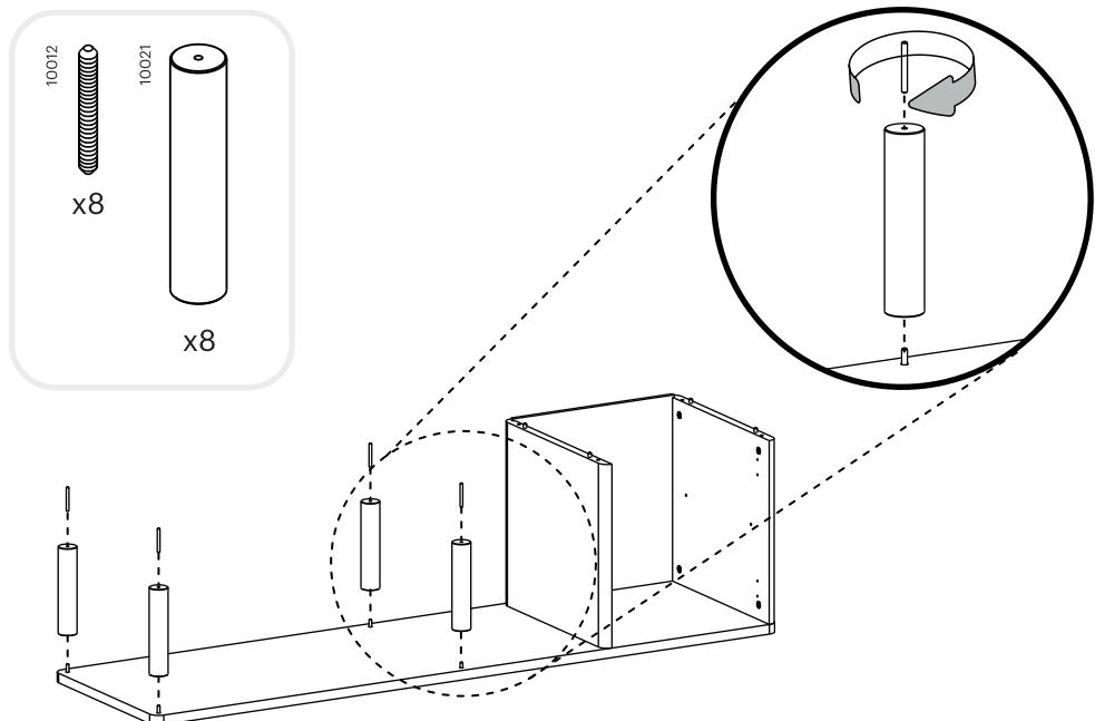
Установите полку окрашенной поверхностью вниз и накрутите стойки, в них вкрутите шпильки.
